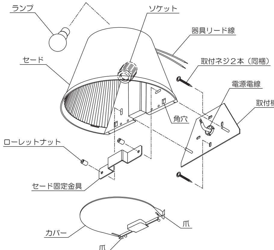
1. 取付板を壁面に取付ネジ2本で取り付けてください。
